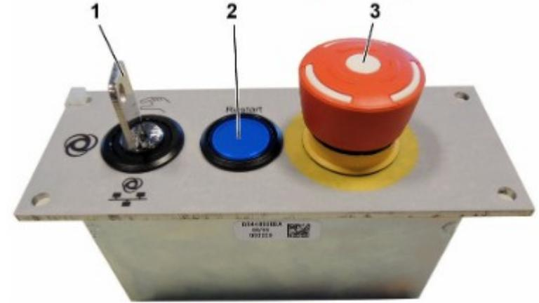
S'il est autorisé par la configuration de la sécurité, le sélecteur de mode de marche (WMS9) est nécessaire pour modifier le mode de marche du robot et pour l'acquiescement du redémarrage de sécurité. Quand le WMS9 est désactivé par la configuration de la sécurité, le mode de marche du robot est sélectionné avec le boîtier de commande manuel.
