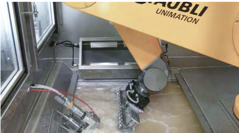
Robot manipulant et orientant des composants automobiles dans la buse d'ébavurage à haute pression
