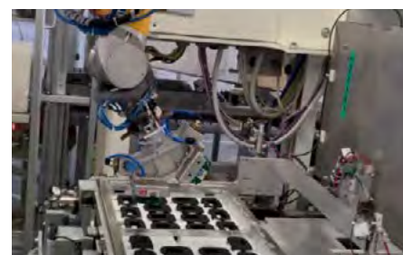
Chargement / déchargement de sous-ensembles électroniques
