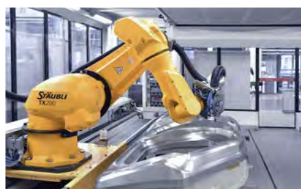
Usinage robotisé de moules : un centre d'usinage robotisé remplace quatre perceuses radiales pour la fabrication de moules.
