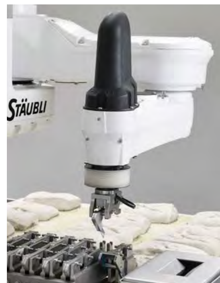
Le TP80 FASTpicker sélectionne la lame adaptée à chaque lot à partir du magasin.
