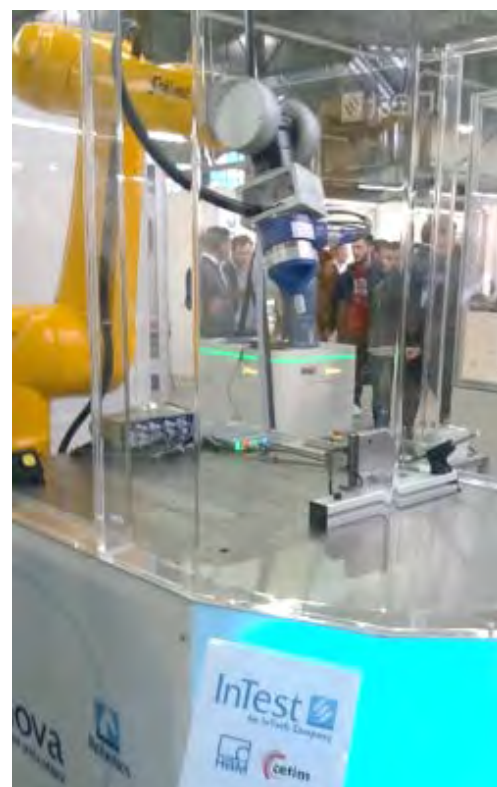
Une application de contrôle basée sur la lecture de défauts par caméra infra rouge
