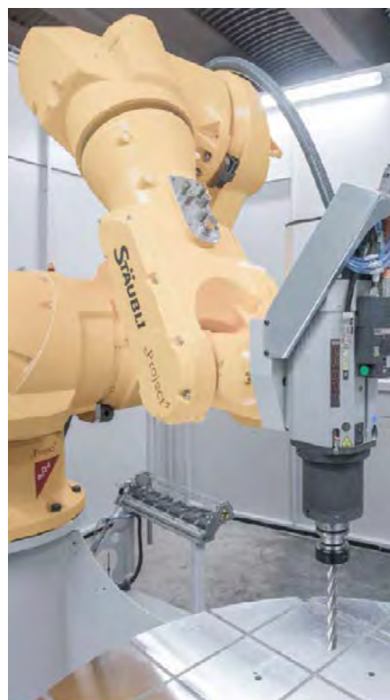
Robot d'usinage avec électrobroche montée sur le poignet
