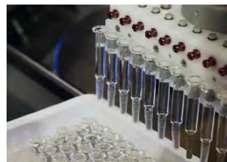
Le préhenseur retire 100 seringues du plateau et les dépose par lots de dix sur un convoyeur.
