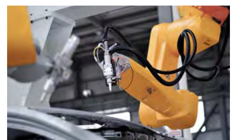
Découpe laser de panneaux de carrosserie: la robotique est plus flexible que les systèmes de découpe laser conventionnels.
