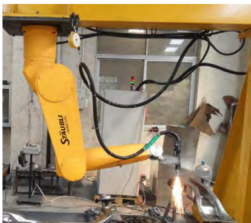
Découpe laser de carrosserie de bus avec robot monté au plafond
