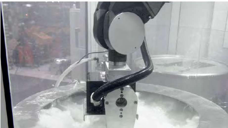
Robot monté au plafond chargeant les composants dans un réservoir de nettoyage
