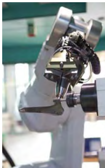
Polissage robotisé de prothèses médicales
