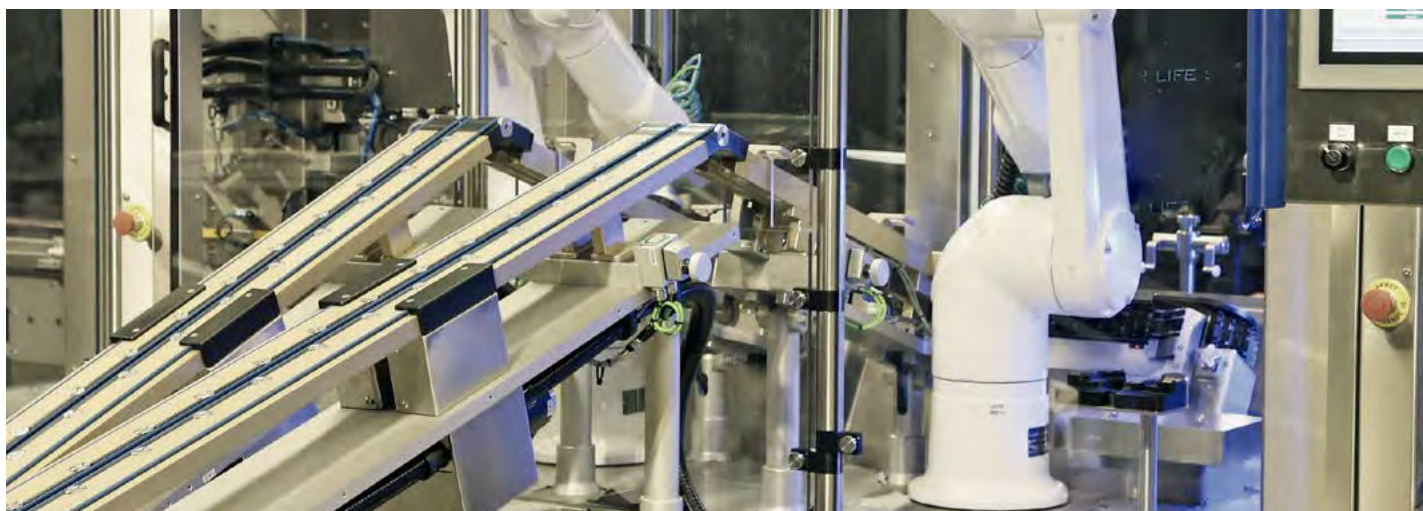
Deux robots six axes Staubli séparent les seringues vides et regroupent les seringues remplies au rythme de 600 unités par minute.
