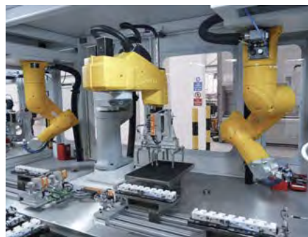
Assemblage de capteurs de contrôle
