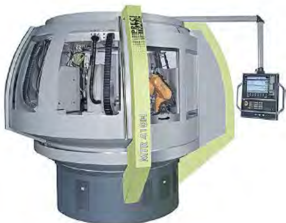
Robot intégré dans une machine à transfert rotatif pour des opérations de chargement / déchargement
